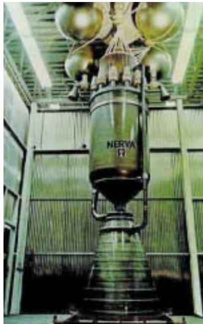
ABD'nin nükleer roket motoru NERVA Motor. 8 m yüksekliğinde. Reaktör ortada ve yakıt tankları üstte.
